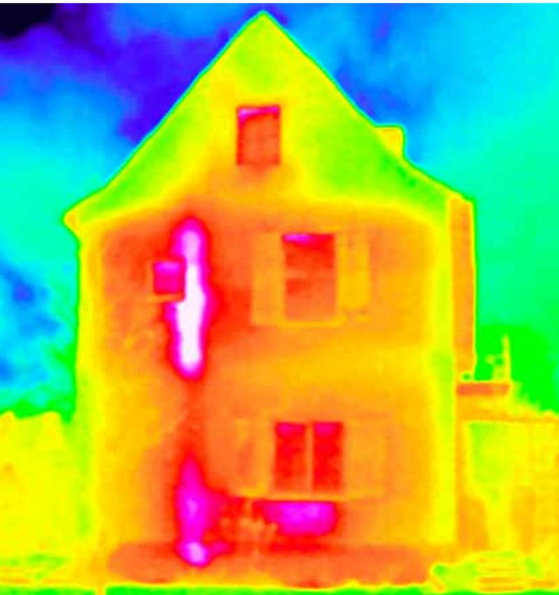
Wärmebilder zeigen die Temperaturverteilung an Objekten und machen so Schwachstellen sichtbar. Bei Rot ist Handeln gefragt.
